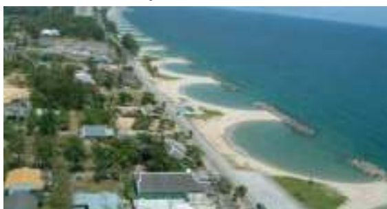
รูปที่ 2.10 เขื่อนกันคลื่นนอกชายฝั่ง (Offshore Breakwater)
