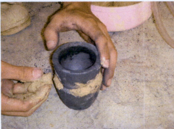
รูปที่ 1 การประกอบครุชีเบิ้ลแกรไฟต์สำหรับเผาพลอย
