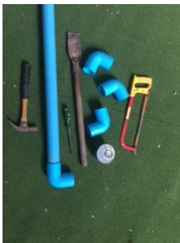
ภาพที่ ๘ เครื่องมือและวัสดุที่ใช้ในงานซ่อมแซมระบบประปา (ที่มา : ภาพถ่ายโดยผู้เขียน)
