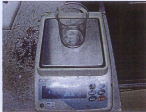
รูปที่ 3.23 การชั่งน้ำหนักสารละลายที่จะนำมาไตเตรท
