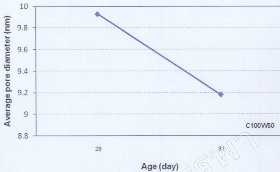
รูปที่ 4.12 ขนาดเส้นผ่านศูนย์กลางเฉลี่ยของโพรงช่องว่างของซีเมนต์เพสต์ มีอัตราส่วนน้ำต่อวัสดุประสานเท่ากับ 0.50 และไม่มีการแทนที่วัสดุประสาน ที่อายุ 28 และ 91 วัน
