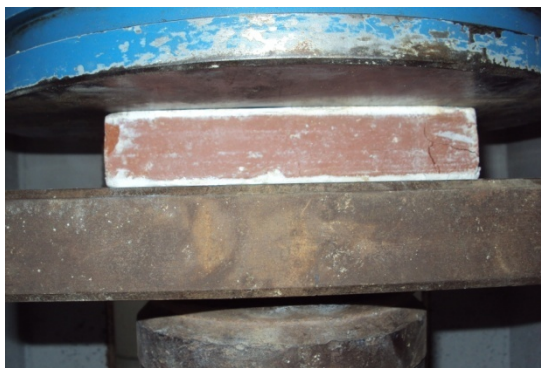
รูปที่ 3.7 การวิบัติของตัวอย่างทดสอบการรับแรงอัด
