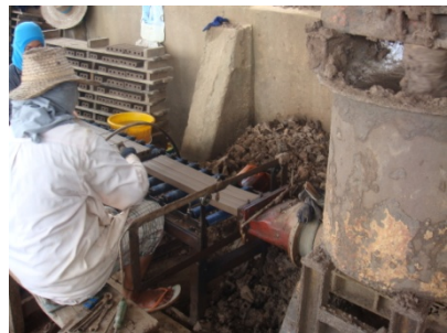
รูปที่ 2.4 การตัดอิฐมอญ
