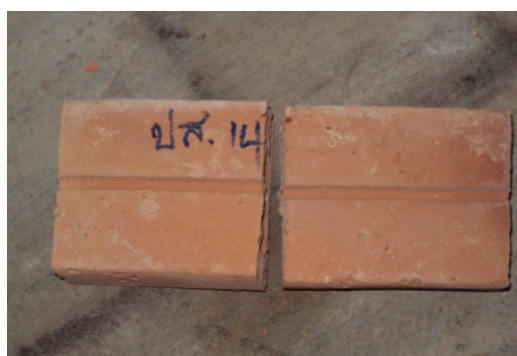
รูปที่ 3.10 การวิบัติของตัวอย่างทดสอบการรับแรงดัด
