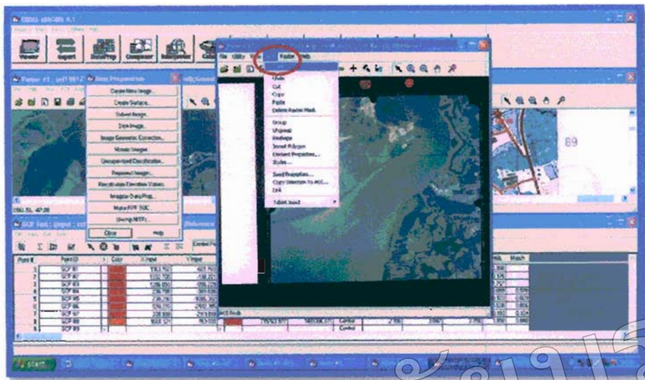
รูปที่ 3.34 ภาพแสดง การใช้เลือก AOI เพื่อเลือกพื้นที่ที่สนใจเท่านั้น
