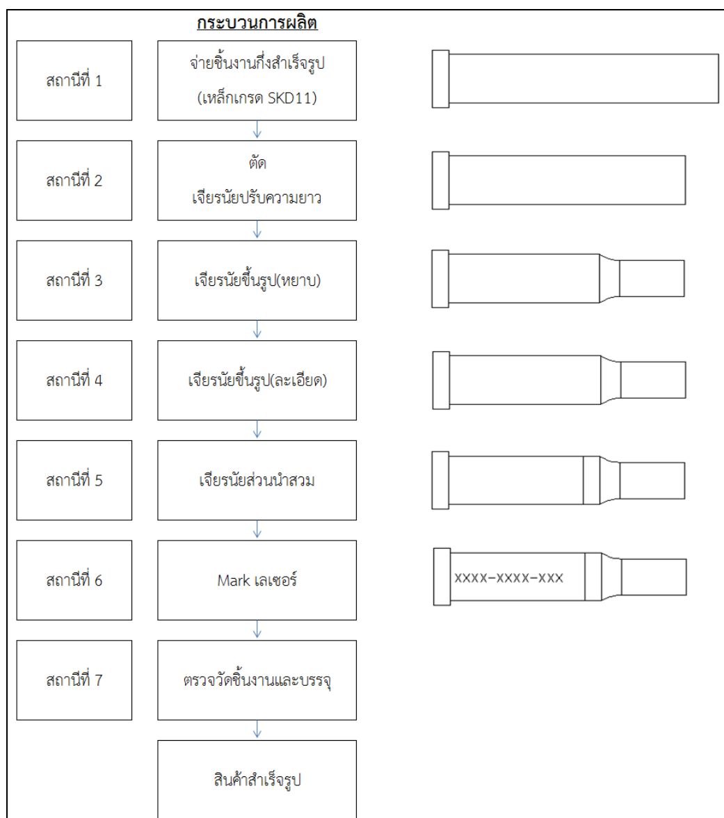
ภาพที่ 4-3 ขั้นตอนกระบวนการผลิตของชิ้นงาน A
