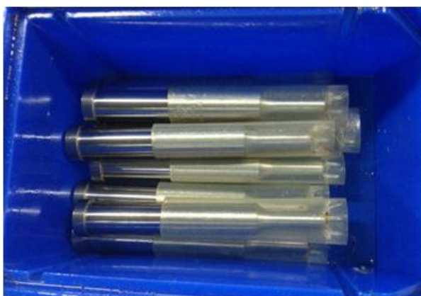
ภาพที่ 4-16 ปกพลาสติกสำหรับหุ้มชิ้นงาน หลังการปรับปรุง
