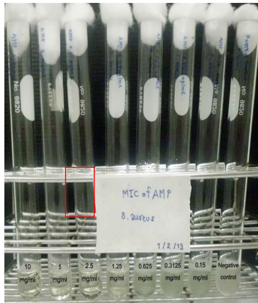
ภาพที่ 4.7 แสดงผลการทดสอบประสิทธิภาพของยาปฏิชีวนะ Ampicillin ต่อการยับยั้งการเจริญเติบโตของ S. aureus ด้วยวิธี Broth dilution test
