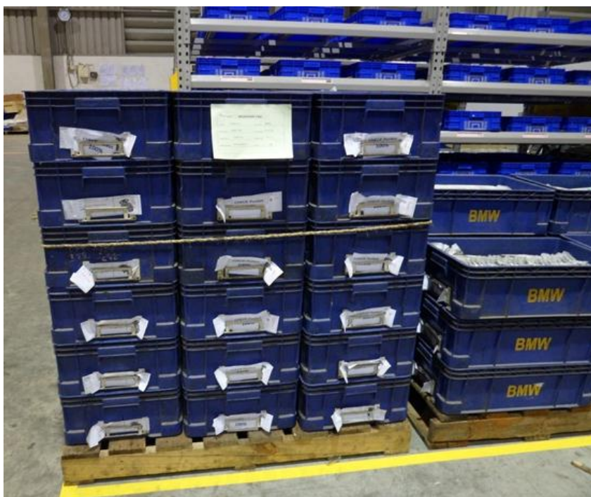
ภาพที่ 4-37 ตัวอย่างการติด Tag รับชิ้นส่วนบนพาเลท (Receive Tag)
