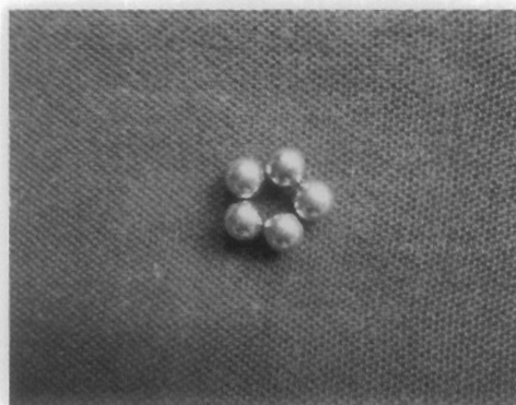
ภาพที่ 3-3 โลหะทรงกลม 3 ขนาด ได้แก่ รัศมี 2.00 2.50 และ 3.00 mm
