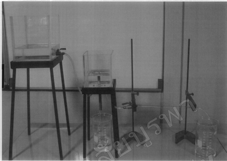
ภาพที่ ข-7 การทดสอบหาค่าการไหลของสารละลายโดยใช้กากถั่ว
