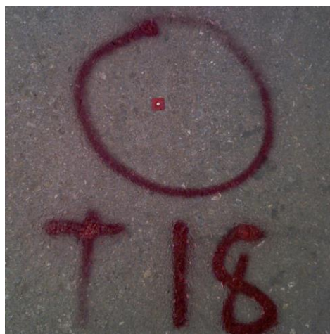
ภาพที่ 28 ตัวอย่างจุดทดสอบที่ทำการสกัดบนพื้นผิวแอสฟัลต์
