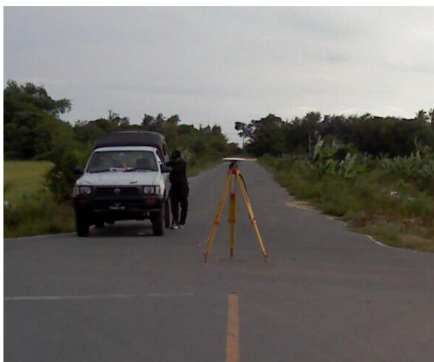
ภาพที่ 29 การรังวัดค่าพิกัดจุดทดสอบด้วยเครื่อง Trimble รุ่น 5700 R7
