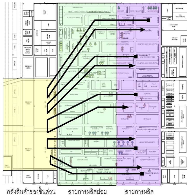
ภาพที่ 4-1 แผนผังโรงงานและตัวอย่างการไหลของการขนส่งลำเลียงชิ้นส่วน
