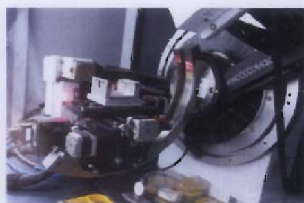
ภาพที่ 3-2 เครื่องเคลือบสุญญากาศระบบรีแอกตีฟดีซีแมกนีตรอนสปัตเตอริงที่ใช้ในงานวิจัย
