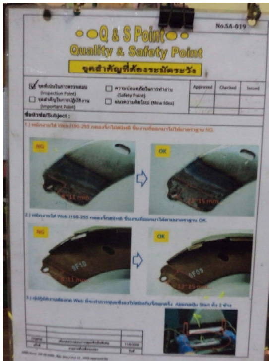
ภาพที่ 3-38 จุดสำคัญในการตรวจสอบก้ามเบรก
