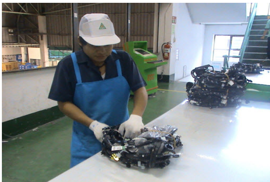
ภาพที่ 3-11 แสดงขั้นตอนการเก็บสายไฟเข้าสไตร์ (Packing)
