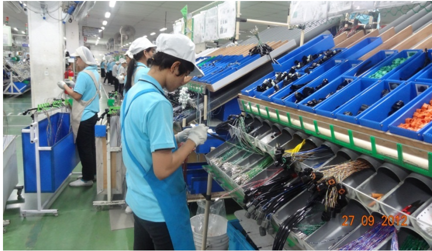
ภาพที่ 3-7 แสดงขั้นตอนการเสียบวงจรสายไฟรยยนต์ (Pre-Blocking)
