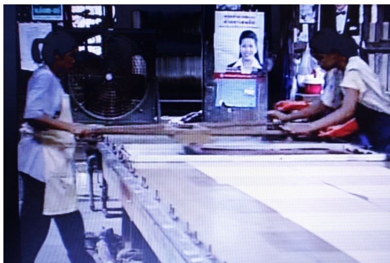
ภาพที่ 4-27 ลักษณะการสกรีนโดยใช้ยางปาดแบบโคมพัสตร์
