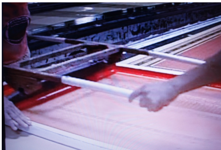
ภาพที่ 4-12 ขางปาดที่ออกแบบเฉพาะโดยมีค้ำจับทั้งสองด้านของโคมพัสเตอร์
