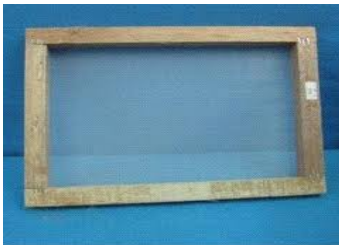
ภาพที่ 4-15 บล็อกสกรีนที่จิ้งตะแกรงใหม่เรียบร้อยแล้ว
