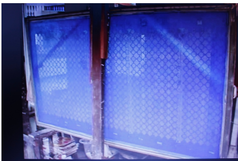
ภาพที่ 4-22 บล็อกสกรีนที่ถ่ายเรียบร้อยแล้วพร้อมสกรีนลาย
