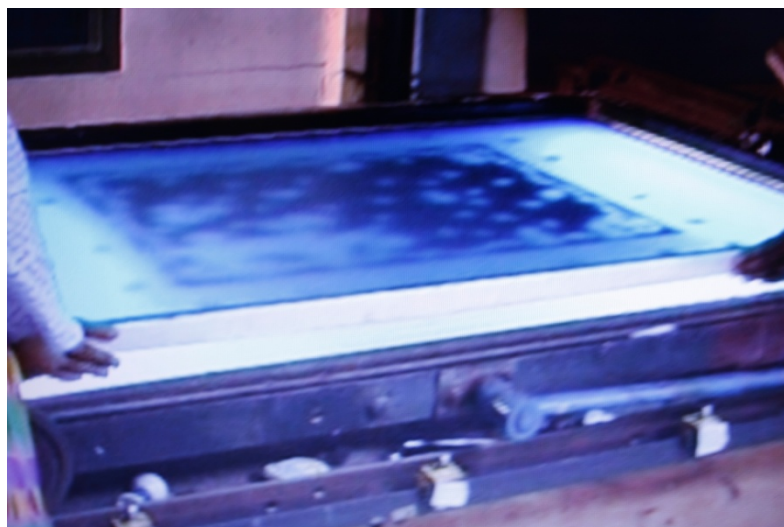
ภาพที่ 4-19 ขั้นตอนการทำแบบโดยนำบล็อกสกรีนไปถ่ายแสง
