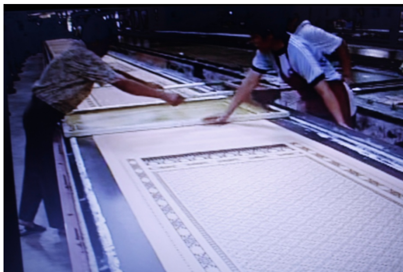
ภาพที่ 4-6 โตะสำหรับสกรีนผ้าเขียวทองโดยเฉพาะ
