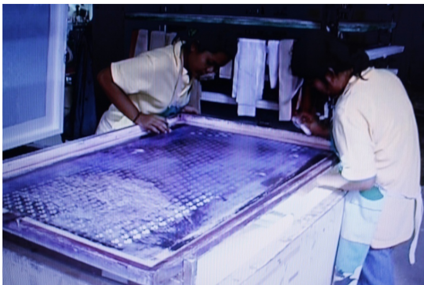
ภาพที่ 4-21 ตรวจสอบแบบและซ่อมด้วยกาวอัดก่อนนำไปสกรีน
