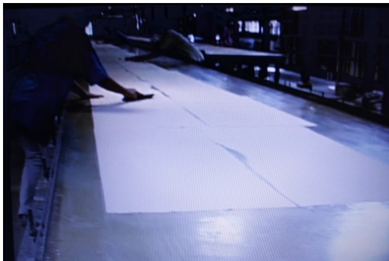
ภาพที่ 4-24 ขั้นตอนการชิงผ้าโดยใช้กาวน้ำรองพื้นผ้าใบเรียบร้อยแล้ว
