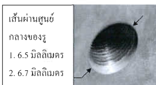
ภาพที่ 3-11 ปิจจัยเส้นผ่านศูนย์กลางกลางของรูไม่ได้ขนาด (เส้นผ่านศูนย์กลางกลางของรู)
