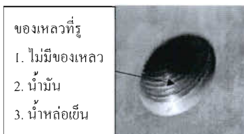
ภาพที่ 3-10 ปิจจัยมีของเหลวเคลื่อนอยู่ในรูของชิ้นส่วน (ของเหลวที่รู)
