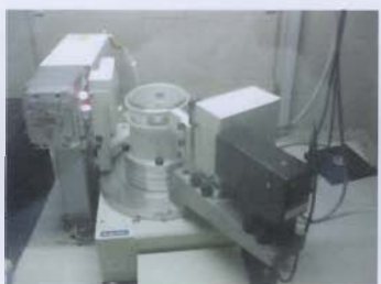
ภาพที่ 3-3 เครื่อง X-Ray Diffractometer (XRD)
