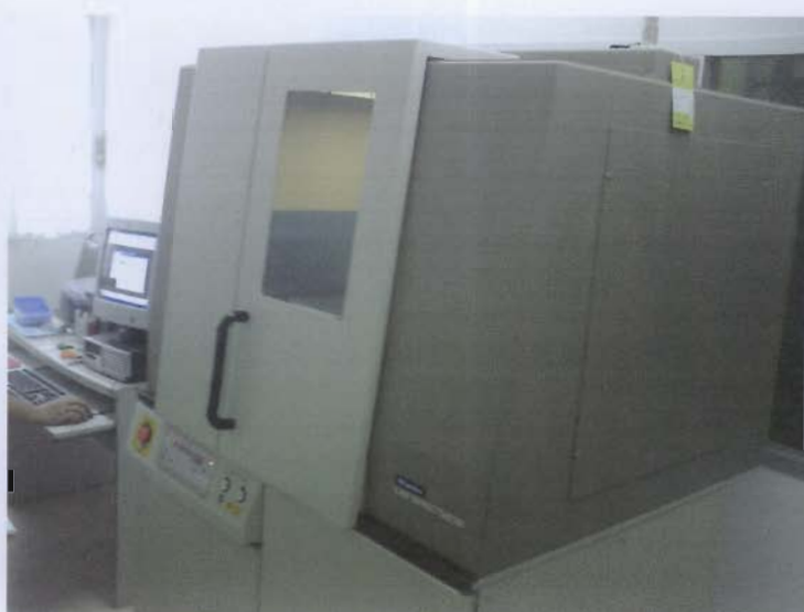
ภาพที่ 3-3 เครื่อง X-Ray Diffractometer (XRD)
