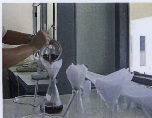
ภาพที่ 18 กรองแยกใบสีกจากน้ำขอมที่สกัดได้
