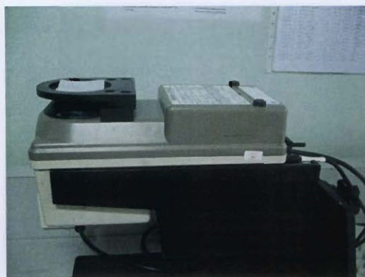
ภาพที่ 22 การวัดค่าสีของผ้าด้วยเครื่องวัดสี
