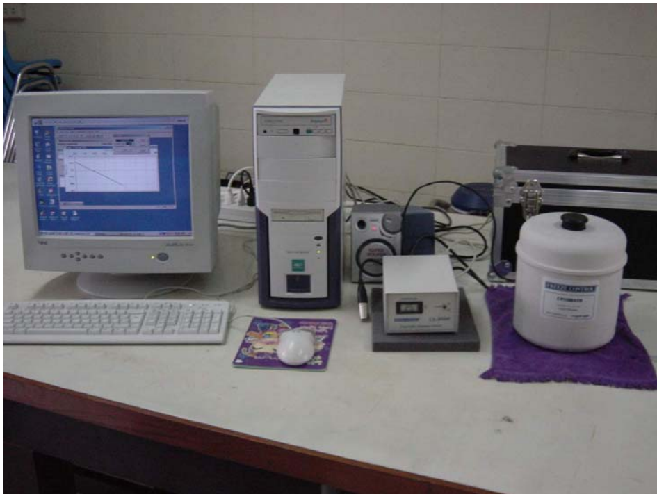
รูปที่ 7 การแช่แข็งน้ำเชื้อปลายี่สกไทยด้วยการใช้เครื่องมือลดอุณหภูมิอัตโนมัติ
