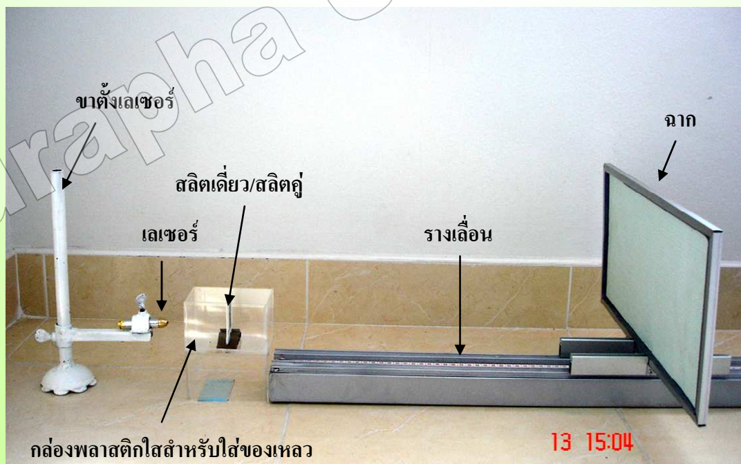
ภาพที่ ก-14 ชุดทดลองวัดค่าดัชนีหักเห กรณีใช้สลิตเดี่ยวและสลิตคู่เป็นตัวเลี้ยวเบนแสง
