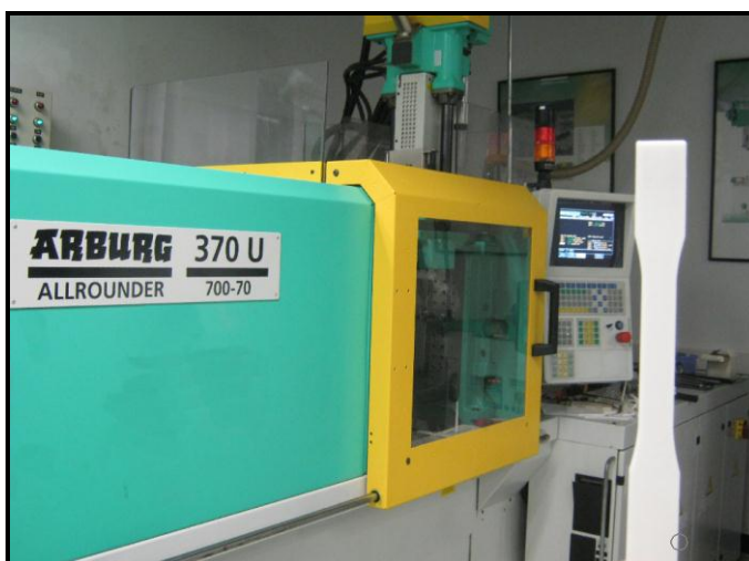
รูปที่ ๓.๗ เครื่องขึ้นรูปแบบฉีด ARBURG ALLROUNDER model 370U
