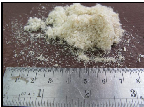
รูปที่ ๓.๔ เส้นใย PALF ที่ถูกตัดด้วยกรรไกรให้มีความยาว 1-3 mm
