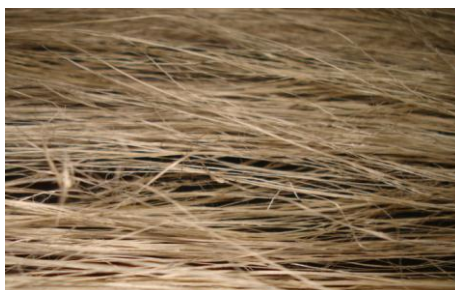
รูปที่ ๔.๒ เส้นใยสับประรดที่สกัดด้วยสารละลายโซเดียมไฮดรอกไซด์
