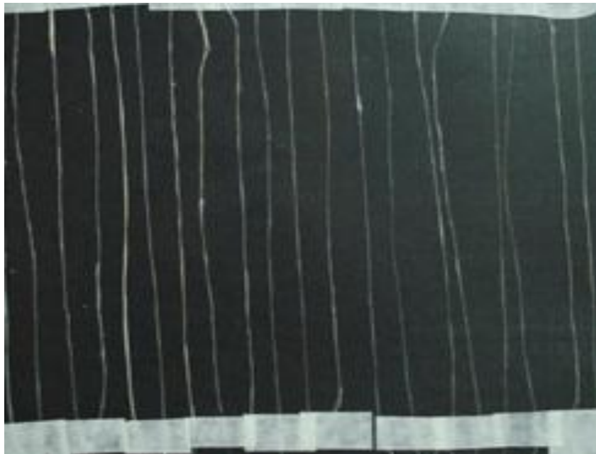
รูปที่ ๒๗ เส้นใยที่สกัดจากใบสับปะรดโดยเครื่องแยกเส้นใย
