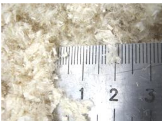
รูปที่ ๕ข เส้นใยสับปะรดที่ตัดให้ได้ขนาด 1-3 mm
