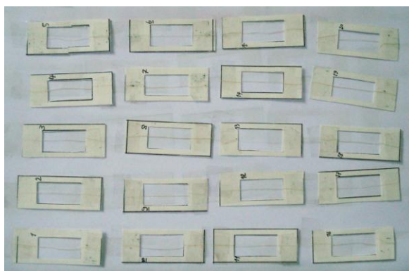
รูปที่ ๔ข การเตรียมตัวอย่างเส้นใยเพื่อทดสอบสมบัติเชิงกลด้วยเครื่องทดสอบแรงดึงเอนกประสงค์
