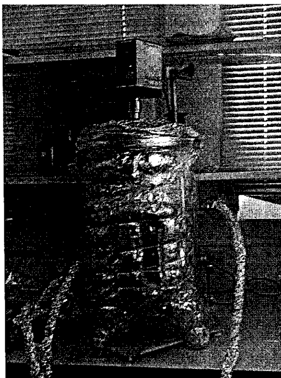
ภาพที่ 4-12 ถึงปฏิกรณ์ชีวภาพขนาด 10 ลิตร เพื่อการขยายขนาดการย่อยแป้งมันสำปะหลังด้วย เอนไซม์
