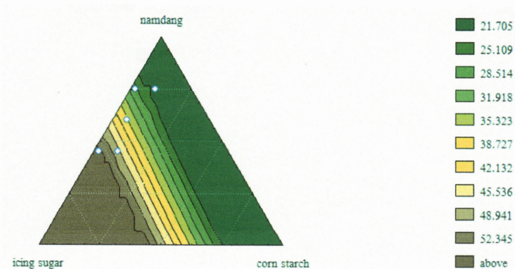
ภาพที่ 4-25 ค่าความแข็งของผลิตภัณฑ์กากผลหนามแดงอัดเม็ดเมื่อแปรส่วนผสมของกากผลหนามแดงผง (namdang) น้ำตาลไอซิ่ง (icing sugar) และแป้งข้าวโพด (corn starch) โดยจัดสิ่งทดลองแบบ Mixture Design
