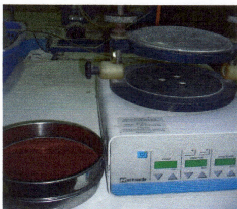
(a) นำกากผลหนามแดงบดมาร่อนด้วยเครื่องร่อน ที่มีตะแกรงขนาด 100 mesh
