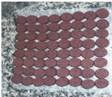
a) นำส่วนผสมต่างๆ มาอัดเม็ดด้วยเครื่องตอกเม็ดด้วยมือ (b) ผลิตรัณฑ์กากผลหนามแดงอัดเม็ด ภาพภาคผนวกที่ ช-6 การผลิตผลิตรัณฑ์กากผลหนามแดงอัดเม็ด (a) และตัวอย่างผลิตรัณฑ์กากผล หนามแดงอัดเม็ด (b)
