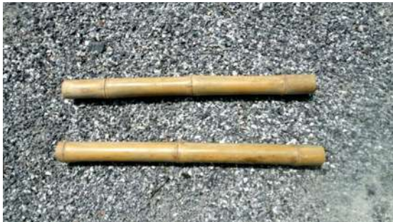
ภาพที่ 91-92 ไม้ตีหนูกหรือ ไม้เหยียบตะกอ
