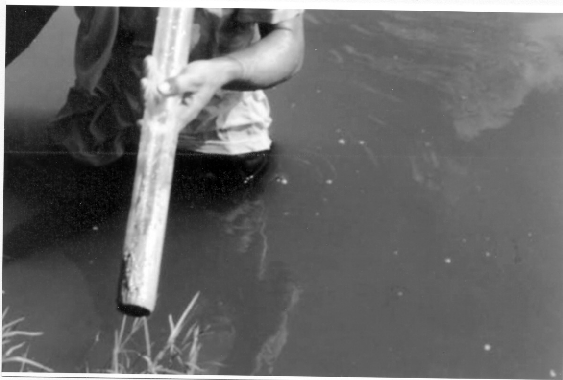
ภาพที่ 10 แสดงลักษณะการเก็บตัวอย่างดินตะกอน
