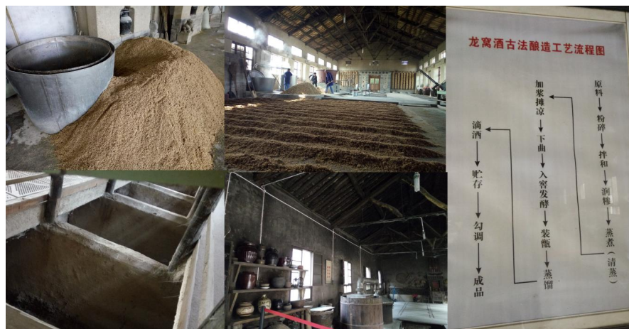
图 11 龙窝酒酿造工艺及流程图 (Liu Yan, 2015)
