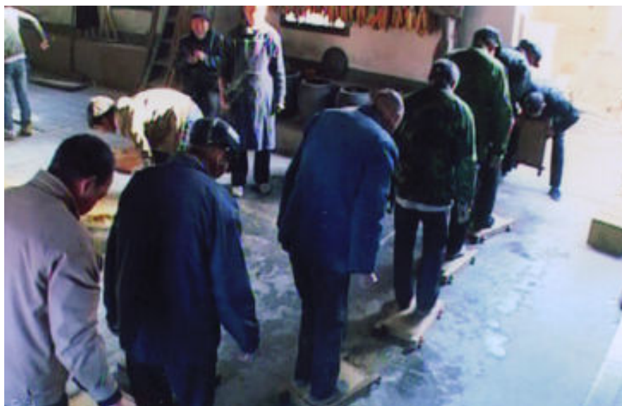
ภาพที่ 3-34 ขั้นตอนการผสมวัตถุดิบด้วยการย่ำเท้า
