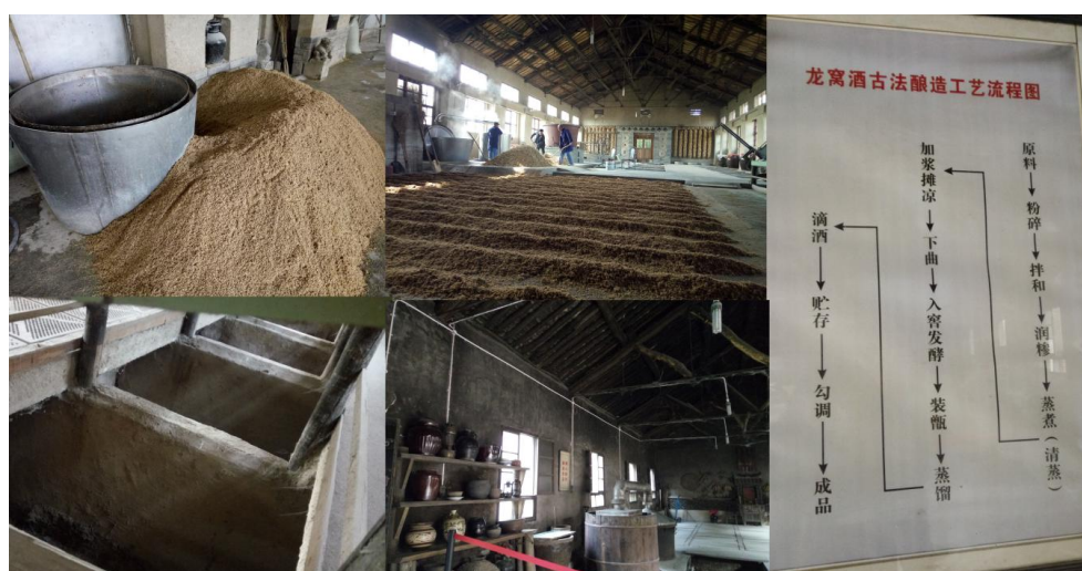
ภาพที่ 3-27 การเตรียมวัตถุดิบอุปกรณ์และแผนภูมิการผลิตเหล้าหลวงวอ
