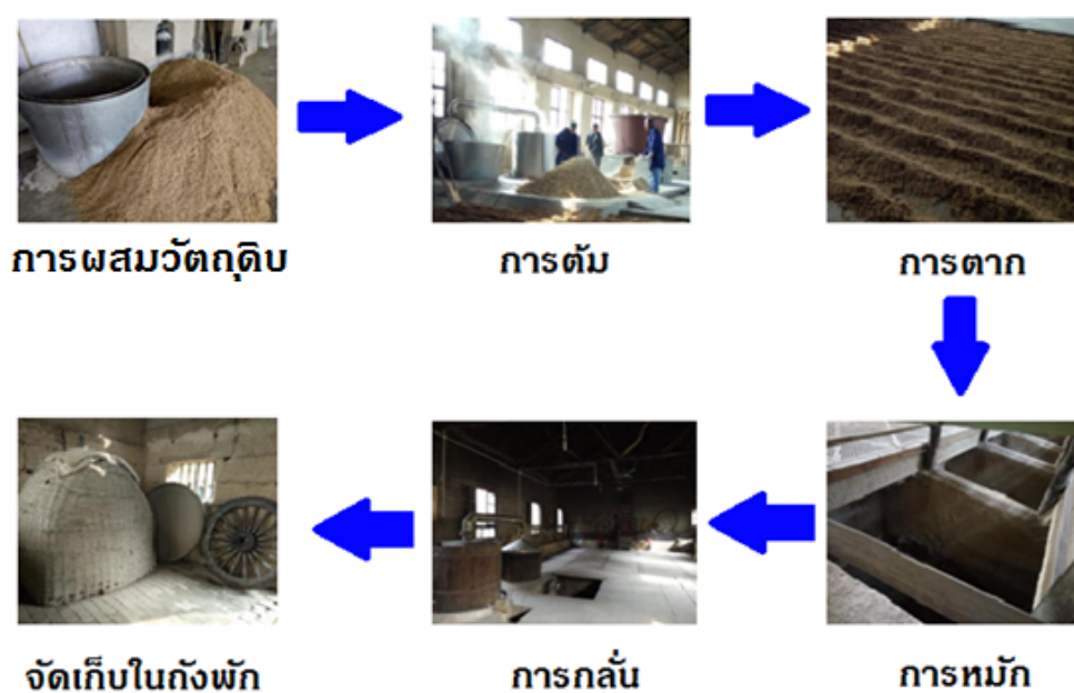
ภาพที่ 3-28 กระบวนการทั่วไปในการทำเหล้าหลวงวอ
