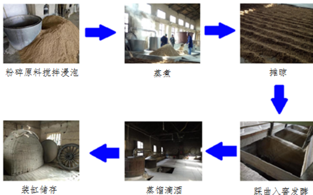
图 16 酿酒工艺流程概括 (Liu Yan, 2015)
