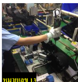
ภาพที่ 3-5 สถานีย่อย ประกอบตู้ทางผ่าน เคสโล สำหรับส่งให้สายการประกอบหลัก
