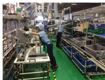
ภาพที่ 3-3 สถานีจัดเตรียมชิ้นส่วนย่อย #1, 2 สำหรับส่งให้สถานีการประกอบหลัก
