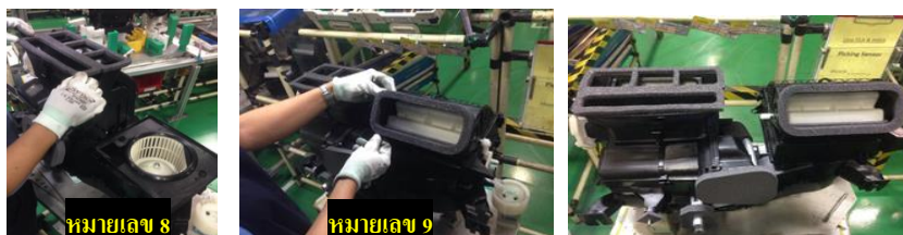
ภาพที่ 3-8 สถานีย่อย การประกอบแผ่นฟองน้ำประตุลม
