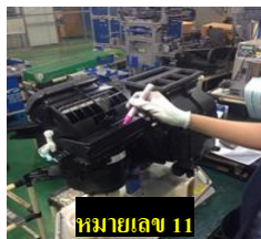
ภาพที่ 3-10 สถานีการตรวจสอบด้วยสายตา
