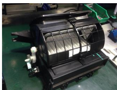
ภาพที่ 3-4 สถานีย่อย ประกอบตู้ทรงกลม สำหรับส่งให้สถานีการประกอบหลัก
