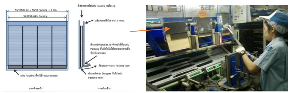
ภาพที่ 4-3 ลักษณะออกแบบอุปกรณ์จับยึดแผ่นฟองน้ำ (Packing) ของสถานีนงานที่ 12
