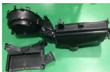
ภาพที่ 3-5 สถานีย่อย ประกอบตู้ทางผ่าน เคสโล สำหรับส่งให้สายการประกอบหลัก
