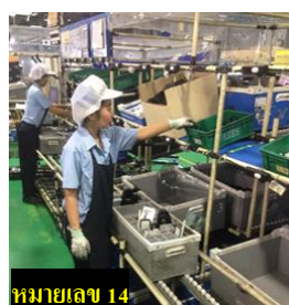
ภาพที่ 3-3 สถานีจัดเตรียมชิ้นส่วนย่อย #1, 2 สำหรับส่งให้สถานีการประกอบหลัก
