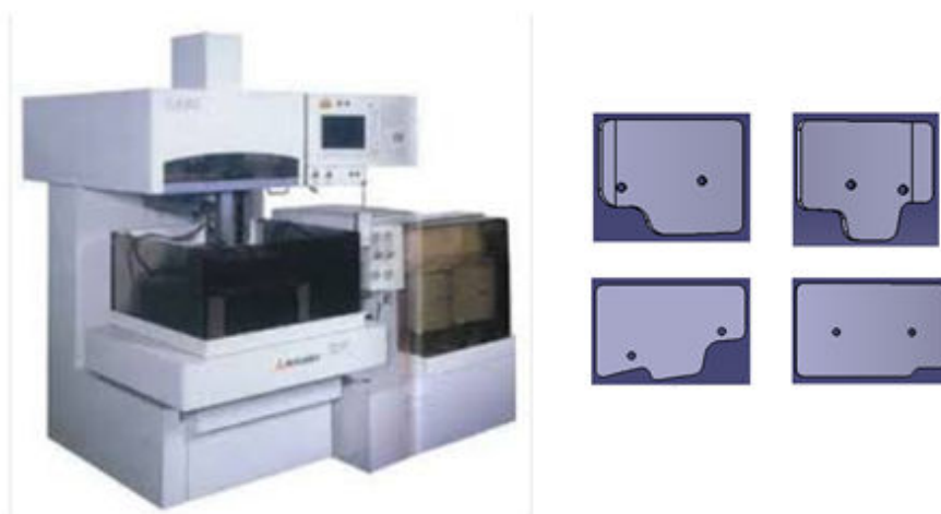
ภาพที่ 4-9 ชิ้นงาน Sipe ที่ตัดจากเครื่อง Wire cut
