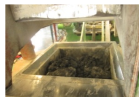
ภาพที่ 4-15 ขั้นตอนเปิดฝาครอบทำความสะอาดเพื่อกวาดสารเคมีที่ตกค้าง
