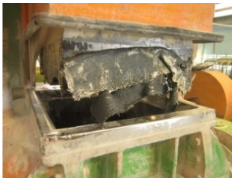
ภาพที่ 4-16 การดึงยางออกจากหัวแรม
