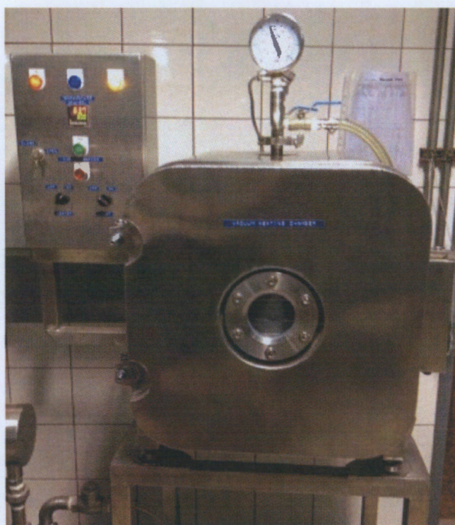
ภาพที่ ง-13 เครื่องอบแห้งสุญญากาศ (Vacuum oven)
