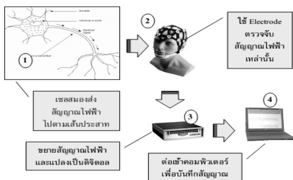
ภาพที่ 14 ขั้นตอนในการจัดเก็บสัญญาณอีอีจี (Sanei, 2007, p. 59)
