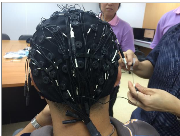
ภาพที่ 40 การสวมหมวกอีลาสติกที่มีขั้วไฟฟ้า (Electrode) 64 Chanel
