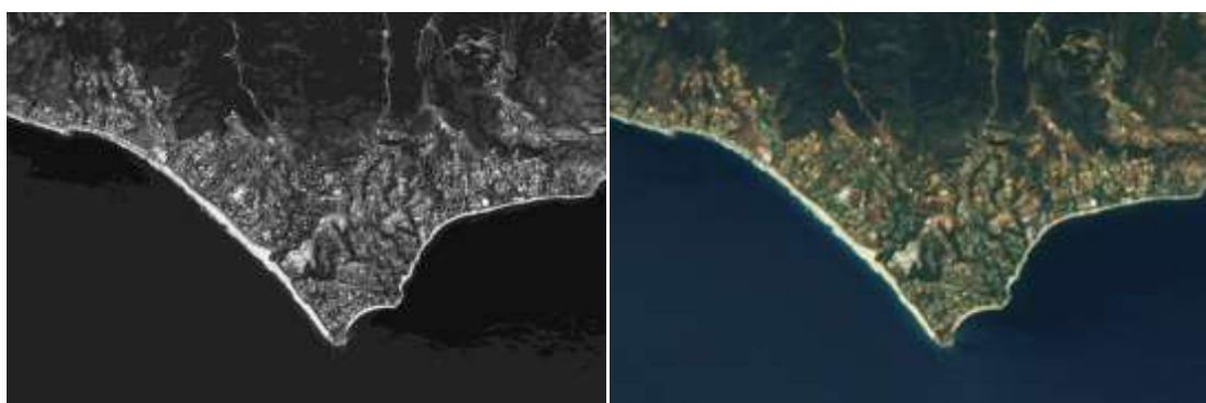
ภาพที่ 10 ภาพจากแบนด์ที่ 8 (ด้านซ้ายมือ) และภาพจากการผสมสี เป็นภาพสีจริง (ด้านขวามือ) ที่มา : United States Geological Survey, 2013
