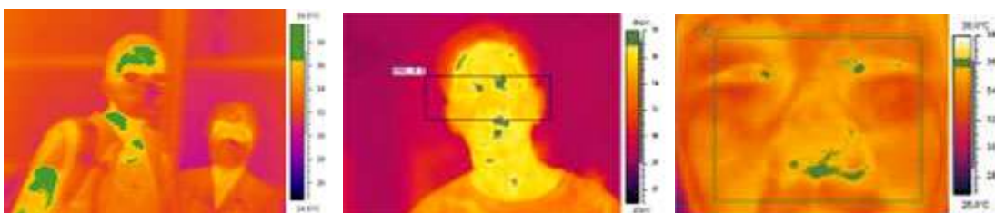
ภาพที่ 15 ภาพถ่ายจากกล้องถ่ายภาพความร้อน สำหรับตรวจวัดอุณหภูมิของร่างกาย ที่มา : บริษัท เทอร์โมสแกน จำกัด, 2555
