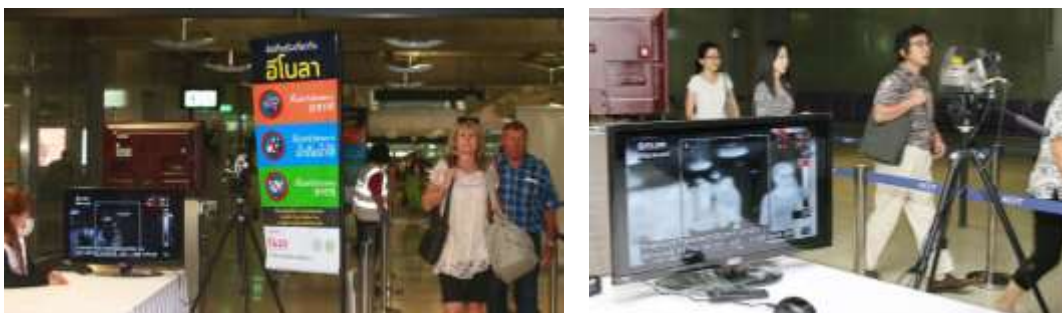
ภาพที่ 14 การนำกล้องถ่ายภาพความร้อนไปใช้สำหรับการคัดกรองผู้ติดเชื้อโรคโควิด-19 ที่มา : บริษัท เทอร์โมสแกน จำกัด, 2555
