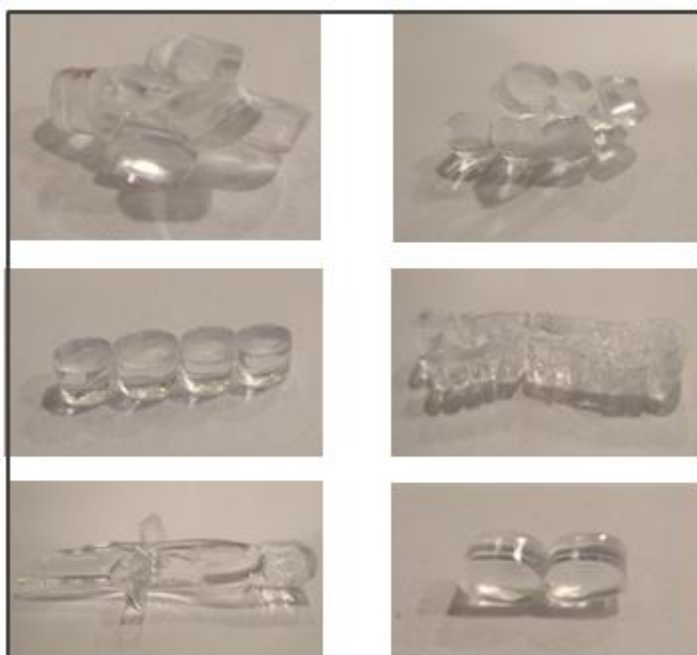
ภาพที่ 4-2 ลักษณะของเม็ดพลาสติกพอลีคาร์บอเนตที่โตเกินมาตรฐาน
