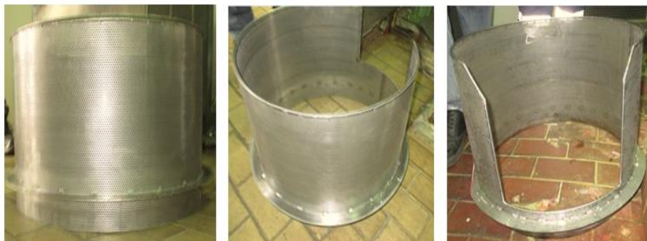
ภาพที่ 4-7 ปลอกกันเม็ดที่สร้างเสร็จแล้ว
