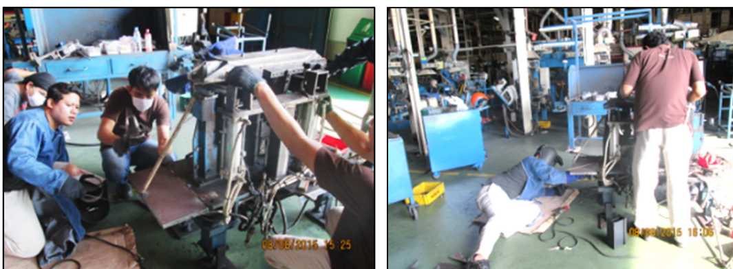
ภาพที่ 4-13 การตัดแปลงและต่อฐานจิ๊กสถานีงานที่ 5
