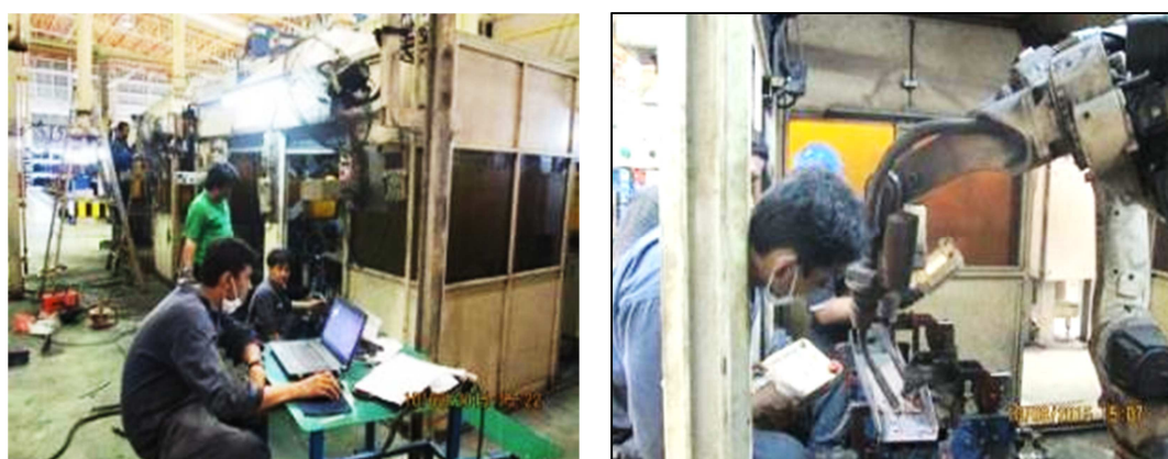
ภาพที่ 4-16 การแก้ไขระบบ PLC และเขียนโปรแกรมการเชื่อมใหม่
