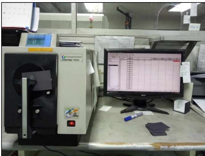
ภาพที่ 3-11 การวัดค่าสีด้วยเครื่องวัดเฉดสี
