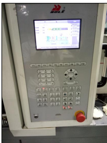
ภาพที่ 3-9 การปรับตั้งค่าเครื่องฉีดพลาสติก
