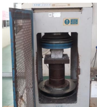
ภาพที่ 3-8 การทดสอบกำลังอัดคอนกรีตด้วยเครื่อง Universal Testing Machine
