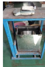
ช. ชุดทดสอบความความถ่วงจำเพาะ
