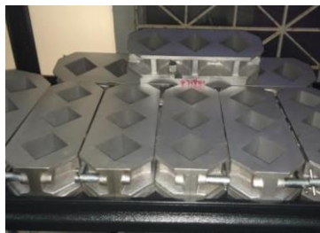
ก. แบบหล่อทรงลูกบาศก์ขนาด 50 x 50 x 50 มม. 3
