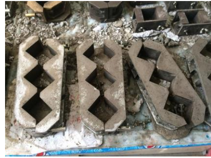
ข. การหล่อมอร์ต้าร์ลงในแบบหล่อ
