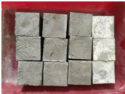
ง. การถอดแบบมอร์ต้าร์หลังหล่อ 24 ชั่วโมงและนำไปป้อนในน้ำต่อเนื่องจนถึงอายุทดสอบ
