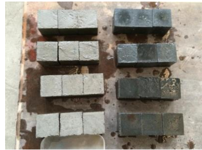
ภาพที่ 3-4 การเตรียมตัวอย่างเพื่อทดสอบกำลังอัดของมอร์ต้าร์
