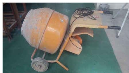
ฉ. เครื่องผสมคอนกรีต
