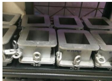
ข. แบบหล่อทรงลูกบาศก์ขนาด 100 x 100 x 100 มม. 3
