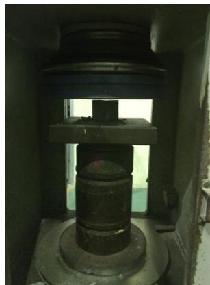
ภาพที่ 3-5 การทดสอบกำลังอัดของมอร์ต้าร์
