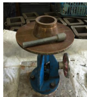
ง. ชุดทดสอบการไหลของมอร์ต้าร์
