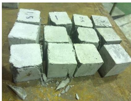
ภาพที่ 3-6 ลักษณะการวิบัติของตัวอย่างมอร์ต้าร์
