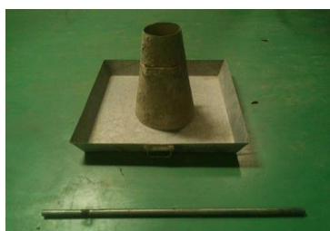
จ. การทดสอบการยุบตัวของคอนกรีต
