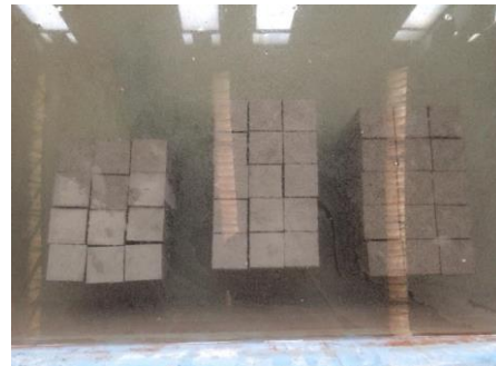
ง. การถอดแบบมอร์ต้าร์หลังหล่อ 24 ชั่วโมงและนำไปป้อนในน้ำต่อเนื่องจนถึงอายุทดสอบ
