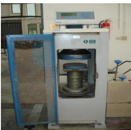
(ณ) เครื่องทดสอบกำลังอัดคอนกรีต
