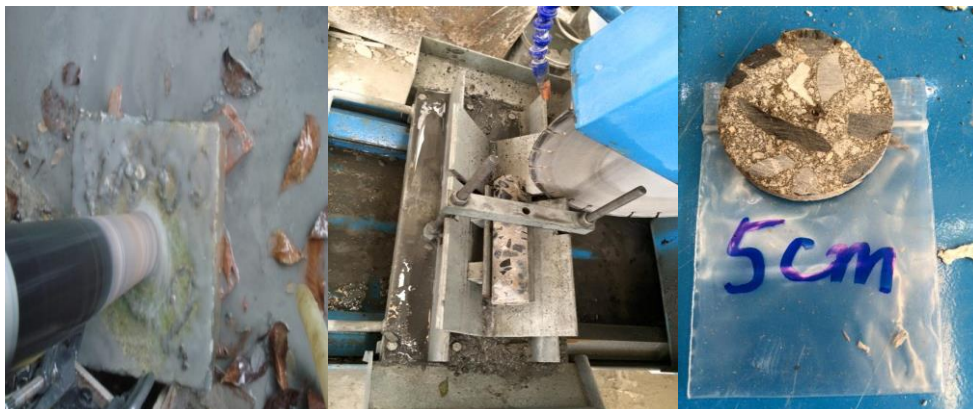
(ก) การเจาะและตัดตัวอย่างคอนกรีต เพื่อใช้ทดสอบหาปริมาณคลอไรด์
