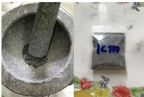
(ข) การบดและเก็บตัวอย่างคอนกรีตเพื่อทดสอบการแทรกซึมของคลอไรด์
