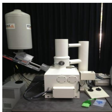
(ณ) เครื่องทดสอบ โครงสร้างจุลภาค โดย (SEM - EDX)
