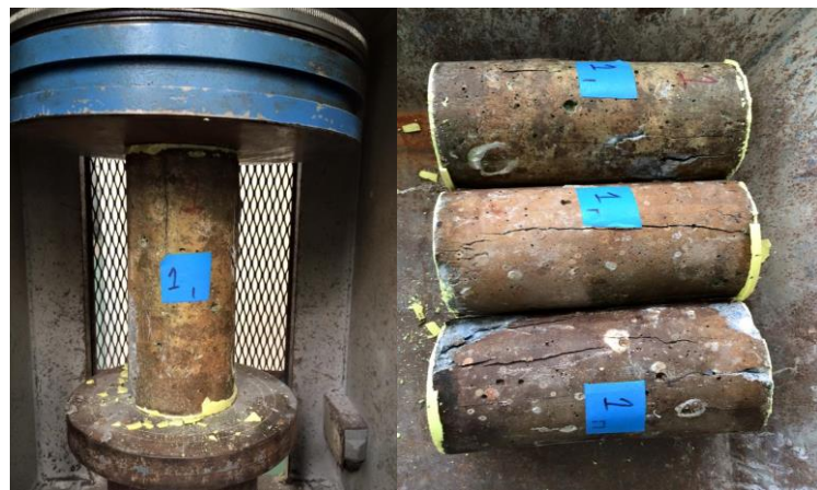
ภาพที่ 3-7 การทดสอบกำลังอัดคอนกรีต
