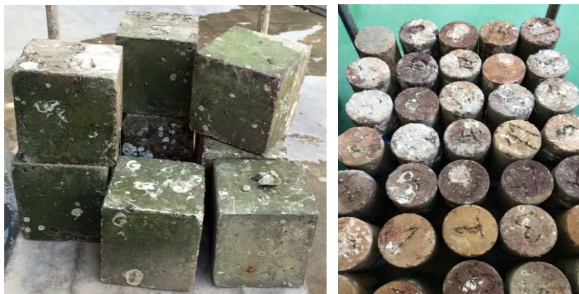
ภาพที่ 4-4 สภาพผิวหน้าคอนกรีตที่ผสมเถ้าปลาล์มน้ำมันบดละเอียดที่แช่น้ำทะเลเป็นเวลา 5 ปี
