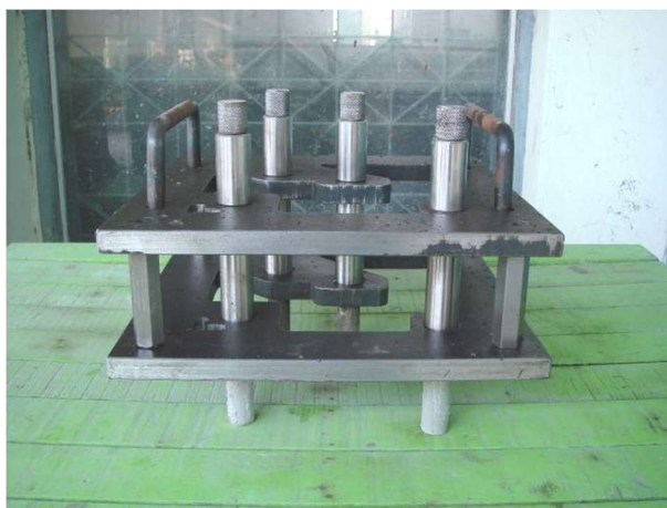
ภาพที่ 3-12 อุปกรณ์กำหนดระยะฝังเหล็กเสริมเหล็กเสริม
