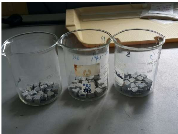
ภาพที่ 3-41 การตัดตัวอย่างเพื่อใช้ในการทดสอบ Micro hardness
