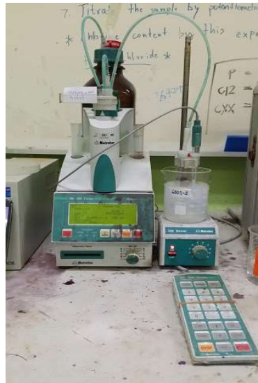
ภาพที่ 3-30 การไตเตรทโดยเครื่อง Potentiometric titration
