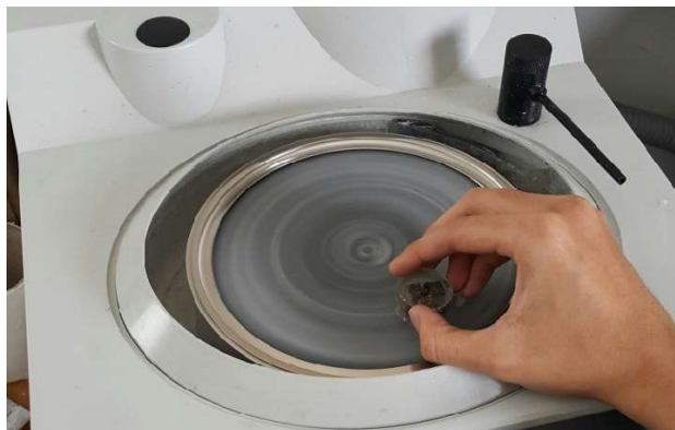
ภาพที่ 3-43 การขัดผิวหน้าก้อนคอนกรีตที่หล่อเรซินแล้ว
