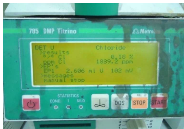
ภาพที่ 3-31 ผลปริมาณคลอไรด์จากการไตเตรทโดยเครื่อง Potentiometric titration
