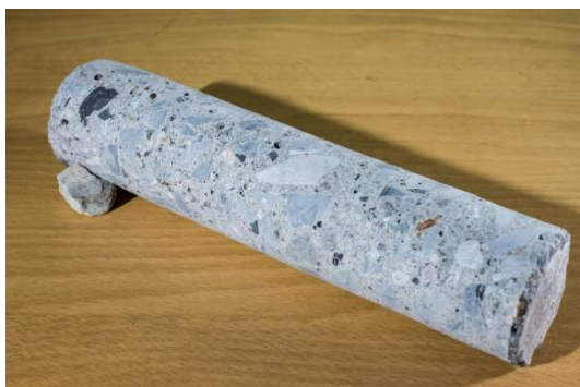
ก. แท่งตัวอย่างคอนกรีตที่เจาะจากก้อนตัวอย่าง
