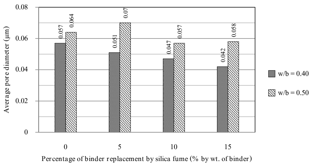
ภาพที่ 4-10 ขนาดโพรงช่องว่างภายในเฉลี่ยของคอนกรีตที่ใช้ซิลิกาฟุ้งแทนที่วัสดุประสาน
