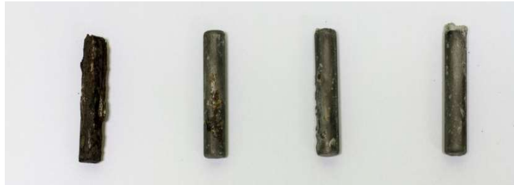
ภาพที่ 3-13 เหล็กเส้นกลมขนาด 12 มม. ยาว 50 มม.
