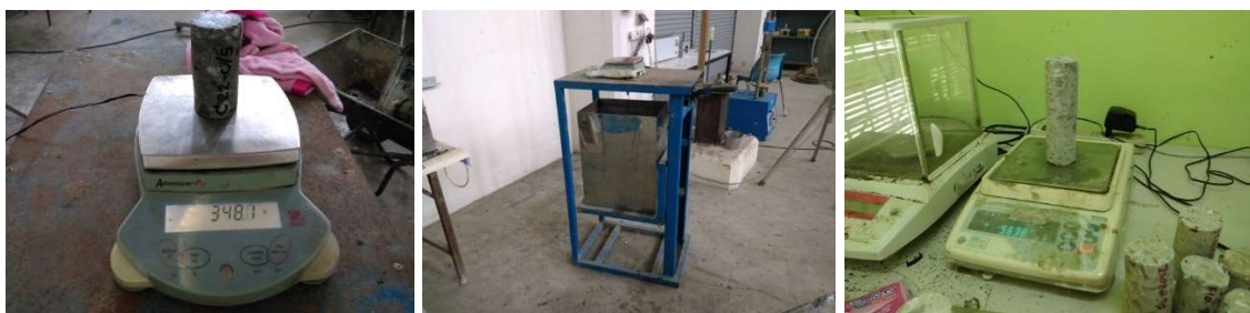
ภาพที่ 3-39 การชั่งน้ำหนักแบบต่าง ๆ ในการทดสอบความพรุนคอนกรีต
