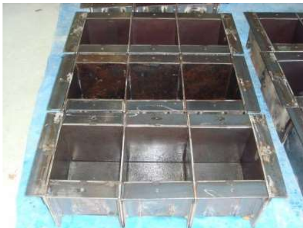
ภาพที่ 3-11 แบบหล่อตัวอย่างคอนกรีตทรงลูกบาศก์ขนาด 20 \times 20 \times 20 ซม. 3
