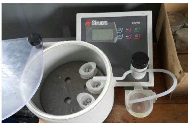
ภาพที่ 3-42 การหล่อเรซินเพื่อยึดตัวอย่างเข้าด้วยกัน
