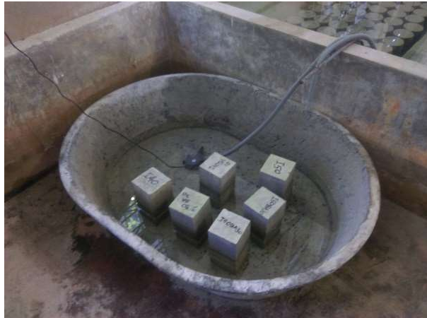
ภาพที่ 3-40 การทดสอบการสะสมความชื้นของคอนกรีตในสภาวะเปียกสลับแห้ง
