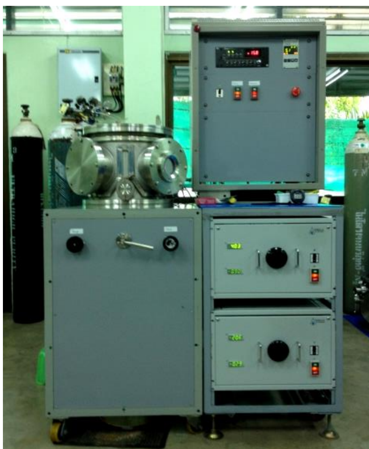
ภาพที่ 3-1 เครื่องเคลือบสุญญากาศระบบรีแอกตีฟดีซีแมกนีตรอน โคอัสต์เตอริงที่ใช้ในงานวิจัย
