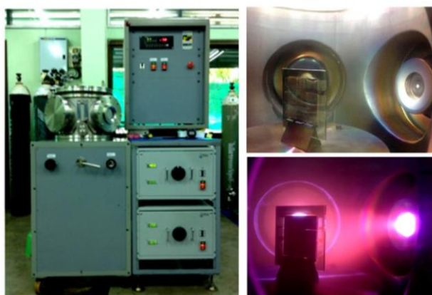
ภาพที่ 1 ลักษณะของเครื่องเคลือบในสุญญากาศและพลาสมาขณะเคลือบ
