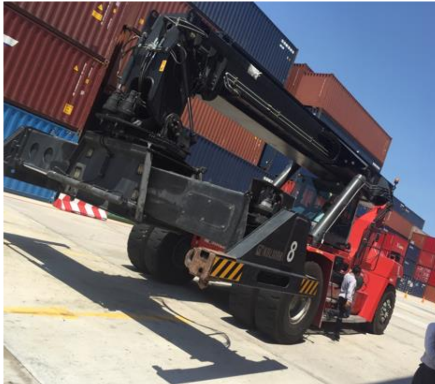
ภาพที่ 4-4 เครื่องจักรเคลื่อนที่ Reach stacker
