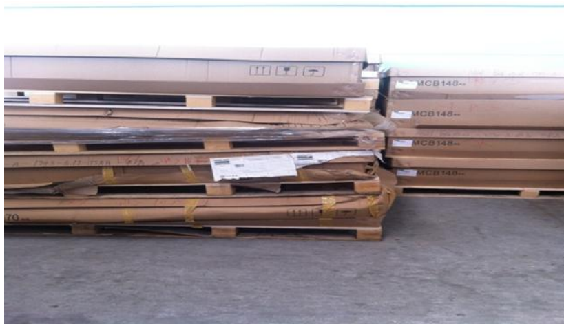
ภาพที่ 4-4 ความเสียหายของกล่องบรรจุชิ้นส่วนประกอบยานยนต์จากการ โคนน้ำฝน
