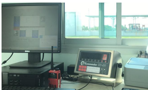
ภาพที่ 4-13 เครื่องควบคุมน้ำหนักในการซ่งเพื่อนำไปขายเป็นเศษเหล็ก
