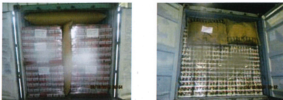
ภาพที่ 4-3 การใส่ถุงลมกันกระแทกเข้าไปในตู้คอนเทนเนอร์
