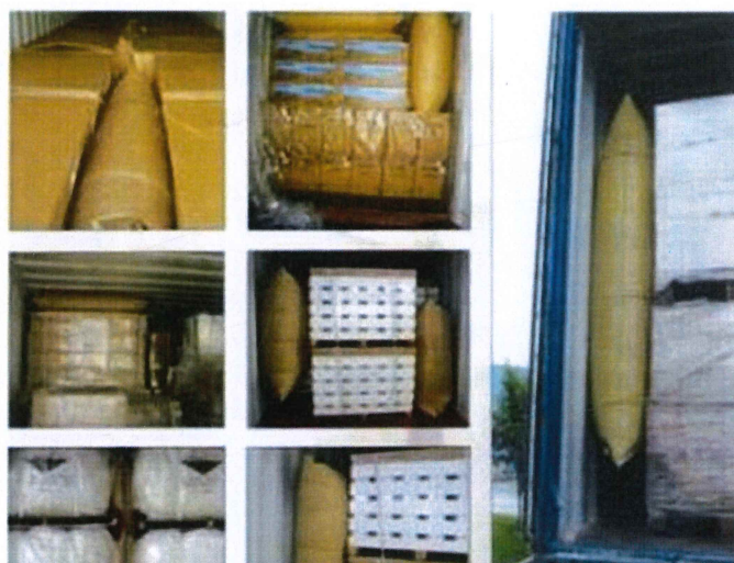
ภาพที่ 2-6 การใส่ถุงลมกันกระแทกในตู้คอนเทนเนอร์เพื่อกันสินค้าเสียหายระหว่างการขนส่ง ที่มา : http://amathailand.com/dunnageairbag.htm
