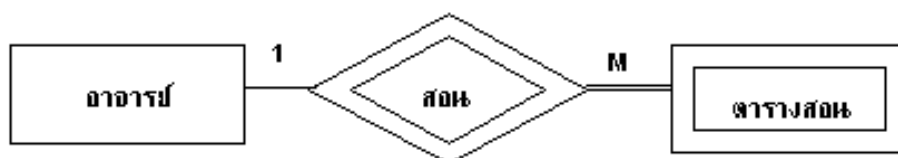
ภาพที่ 1.18 ความสัมพันธ์ แบบ Existence Dependency
