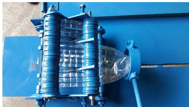
เครื่องตัดเส้นขวดน้ำพลาสติกสำหรับทำไม้กวาด
