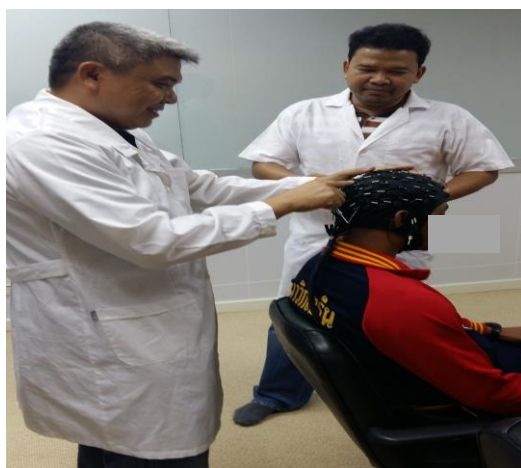
ภาพที่ 46 การสวมหมวกที่มีขั้วไฟฟ้า (Electrode) และการบรรจุน้ำเกลือ (Electrolyte) เพื่อนำสัญญาณไฟฟ้า
