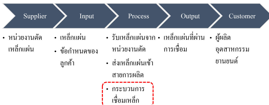
ภาพที่ 4-1 การวิเคราะห์กระบวนการผลิตเสาประตुरถยนต์
