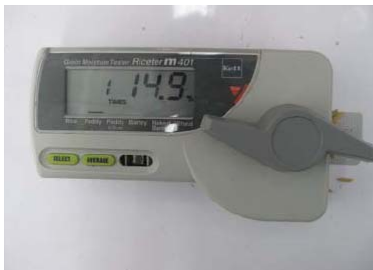
ภาพที่ 3-4 การวัดเปอร์เซ็นต์ความชื้นข้าวเปลือก
