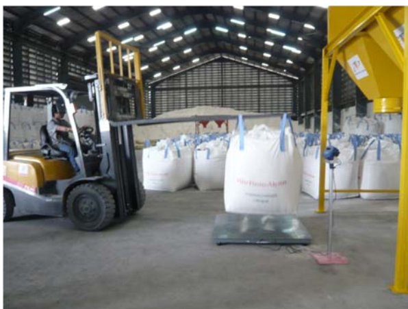
ภาพที่ 3-8 การชั่งน้ำหนักข้าวด้วยเครื่องชั่งดิจิตอล
